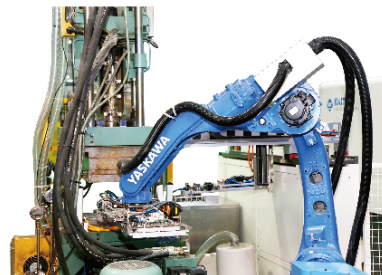
程控机器人，实现全程无人刷柄主胶流程 Programmable robot: full-automatic rubber injection
